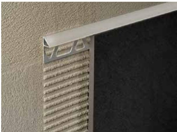
Trialjolly TJ consiste en un perfil que permite crear rápidamente un accesorio elegante en las paredes revestidas de cerámica, que no cubren toda la pared. Trialjolly TJ nace para mitigar los bordes afilados que se crean cuando la baldosa se realiza parcialmente en la pared. El ángulo de 45° creado por el perfil decora de forma precisa y funcional el borde de la baldosa, que de otro modo sería antiestético y cortante.
